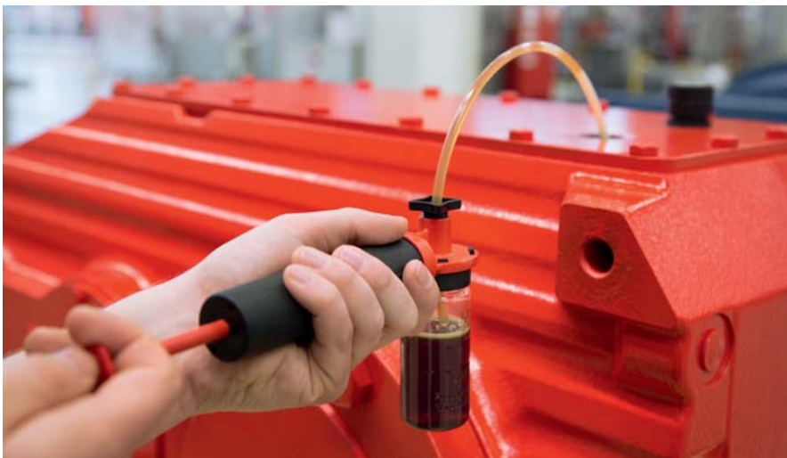
Probennahme aus einem SEW-EURODRIVE Großgetriebe. OELCHECK-Ölanalysen passen perfekt zum Condition-Monitoring-Service von SEW-EURODRIVE.
