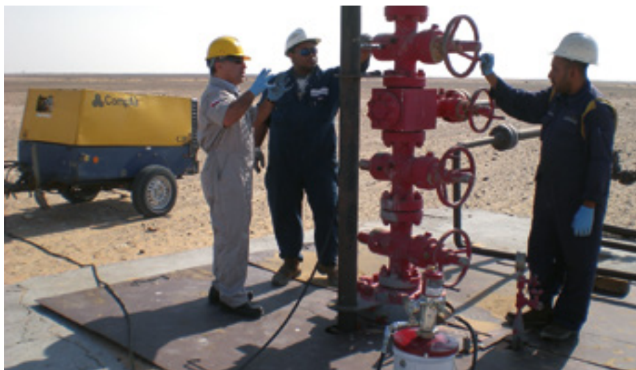
Ein "Xmas Tree" auf einem Ölfeld in Oman. Das Eruptionskreuz schließt das Bohrloch ab. Damit dies absolut zuverlässig geschieht, liefert Milispec die Spezialschmierstoffe für die Ventile.
