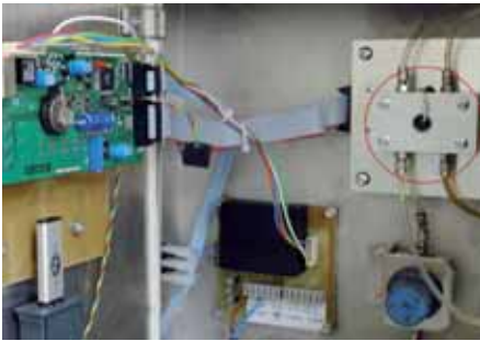
IR-Sensor zur Bestimmung des Wassergehaltes in ppm
