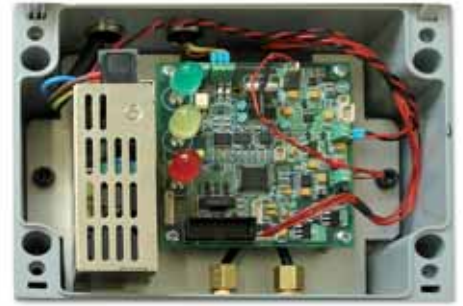
Visible-Light-Sensor für die Messung des Oxidationsindex und der AN
