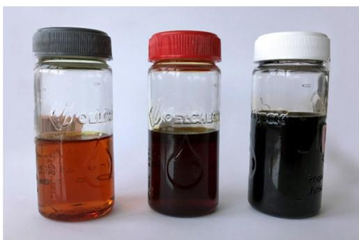
**Bild 1:** Schmieröle aus verschiedenen Anwendungen nach etwa gleicher Einsatzzeit
