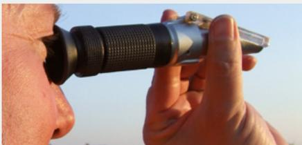
Die einfachste Bestimmung des Brechungsindex erfolgt mit einem Hand-Refraktometer. Es nutzt dafür das Verhalten von Licht am Übergang zwi-
