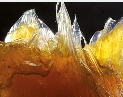
Wenn eine Schmierstelle nicht perfekt mit Öl versorgt werden kann, kommt in der Regel ein Schmierfett zum Einsatz. Schmierfette müssen aber nicht nur für eine optimale Schmierung sorgen, sondern oft auch die Schmierstellen abdichten und bewegte Teile vor Verschleiß und Verunreinigungen schützen. Sie sollen Stoßbelastungen abdämpfen und sich im
