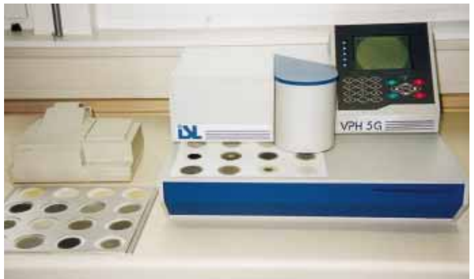
CCD Photometer im WEARCHECK-Labor – links vorbereitete Tüpfel der Ölproben
