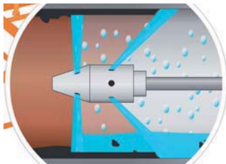
Schema der hydrodynamischen Reinigung
