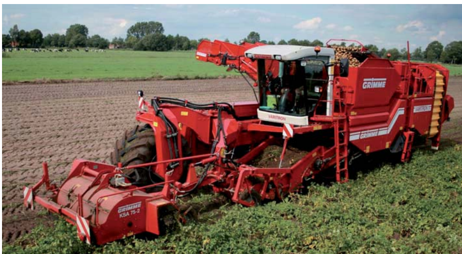
Ein Kartoffelvollernter im Einsatz: Der Selbstfahrer Variton 270
