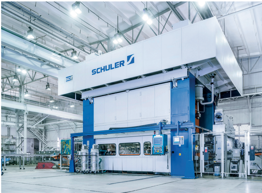
Typisch Schuler: Eine Servopresse in Zugankerbauweise mit 11.000 kN Presskraft. Hydraulikölfüllmenge > 5.000 l.
