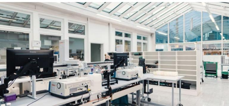
*Das OELCHECK-Labor umfasst 2.350 m<sup>2</sup>. Hier sind derzeit mehr als 130 Untersuchungsgeräte täglich im Einsatz. Dazu zählen: 6 Infrarot-Spektrometer | 5 ICP-Spektrometer | 5 Gaschromatographen | 7 Partikelzähler | 20 Viskosimeter mit Temperierbädern zur Bestimmung der Viskosität bei 40 und 100 °C | 22 Titratoren zur Bestimmung von Säure- und Basenzahlen.*
