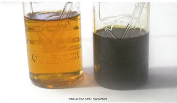
Abbildung 5: links: frisches Hydrauliköl, rechts: nach „Dieseleffekt“
