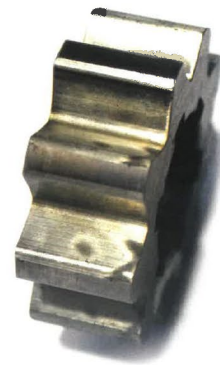
Kavitationsschäden an einer hydraulischen Zahnradpumpe
