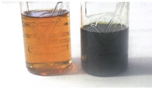
links: frisches Hydrauliköl, rechts: nach „Dieseleffekt“
