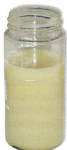
Hydrauliköl mit emulgiertem Wasser
