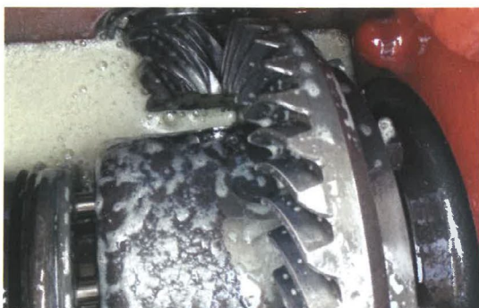
Oberflächenschaum in einem Getriebe
