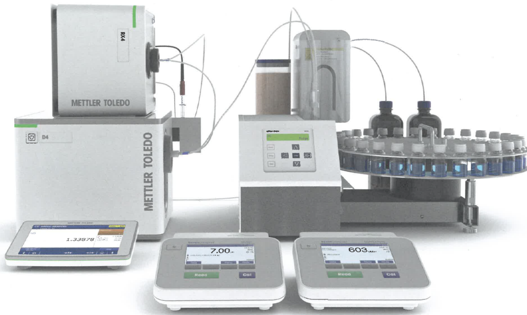
Abbildung 2. Das System von OELCHECK im Detail. Ein Dichtemessgerät und ein Refraktometer (links) werden mit pH- und Leitfähigkeitsmessgeräten (vorn, Mitte) verbunden; Proben werden vom SC30-Probenwechsler (rechts) mithilfe einer Pumpe (hinten, Mitte) in die Messzellen der Geräte übertragen. Der Arbeitsablauf wird von der LabX-Software gesteuert, Resultate werden für die Archivierung automatisch an das LIMS von OELCHECK weitergeleitet.
