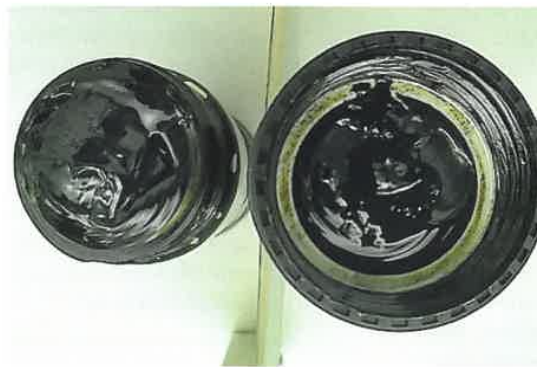
Stark eingedicktes Dieselmotorenöl nach nur 150 Betriebsstunden. Hier funktionierte die Verbrennung des Motors nicht richtig. (Bild: Oelcheck)
